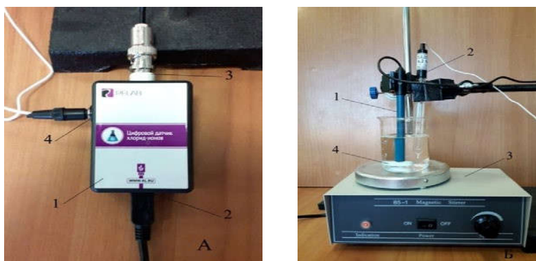
Рис.2. Установка для определения концентрации (активности) хлорид-ионов в растворе. А: 1 — корпус датчика для определения \text{Cl}^- -ионов; 2 — разъём MicroUSB для подключения к компьютеру; 3 — разъём BNC для подключения рабочего электрода; 4 — разъём для подключения электрода сравнения. Б: 1 — ионоселективный электрод (рабочий электрод); 2 — электрод сравнения (хлорсеребряный электрод); 3 — магнитная мешалка; 4 — якорь магнитной мешалки
